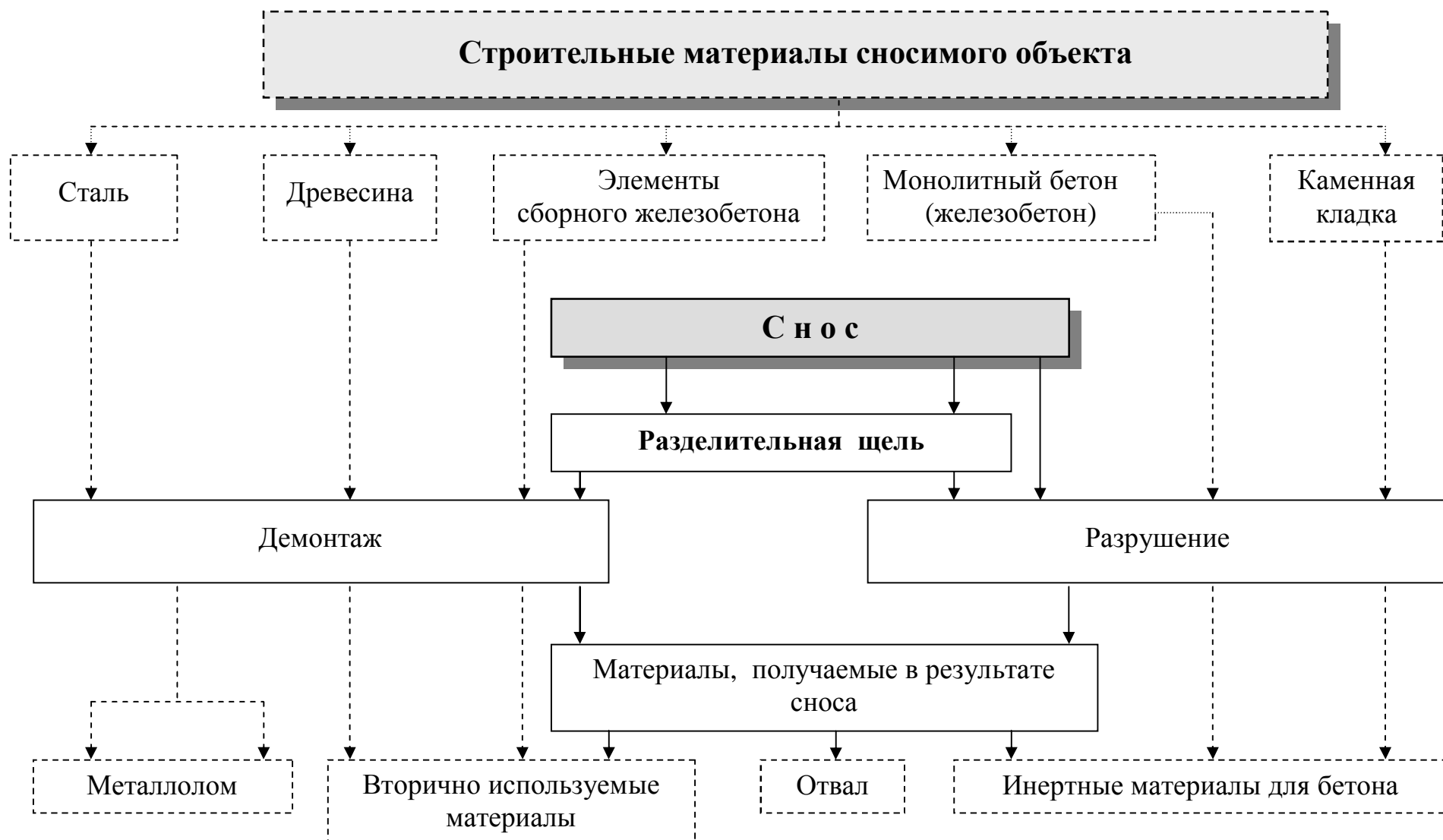
Рис. 3.2. Взаимосвязь между строительными материалами сносимого объекта, способом сноса и дальнейшим использованием этих материалов
