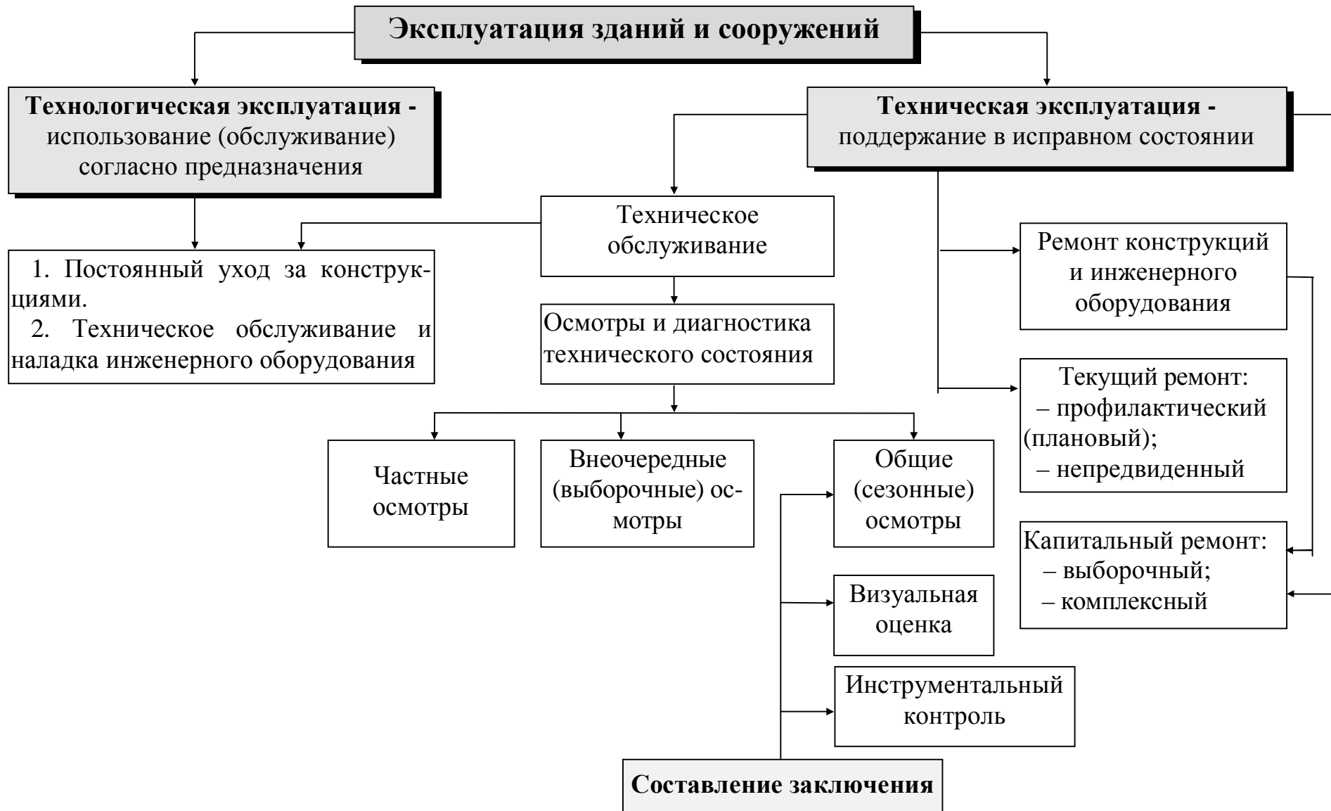
Рис. 1.1. Состав мероприятий по эксплуатации зданий и сооружений
