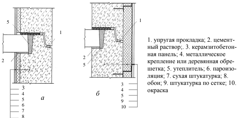
Рис. 5.13. Пример утепления стен: а) изнутри помещения; б) утепление фасада.
