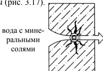
Рис. 3.17. Кристаллизационное разрушение бетона.
