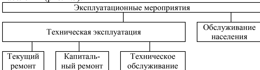
Рис. 1.5. Комплекс эксплуатационных мероприятий.
