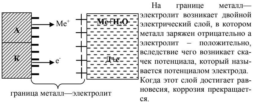
Рис. 3.3. Электрохимический механизм разрушения металла.
