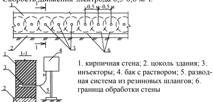
Рис. 5.7. Восстановление гидроизоляции подземной части здания инъектированием.
