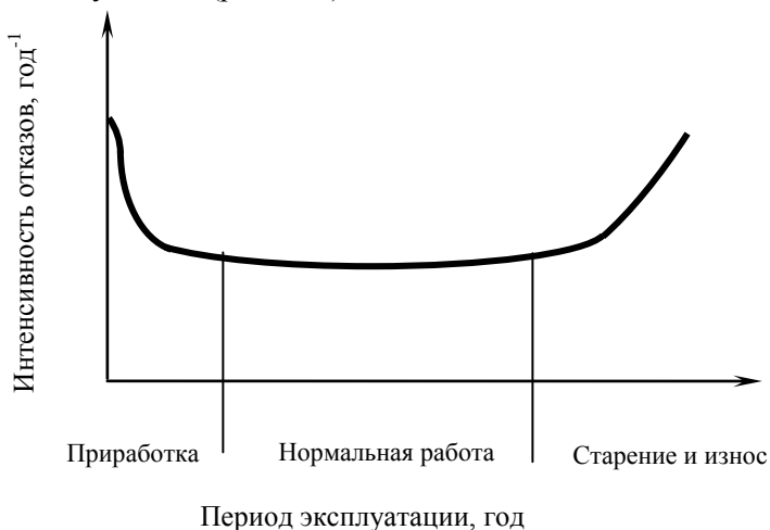
Рис. 1.2. Изменение интенсивности отказов в течение эксплуатационного периода.
