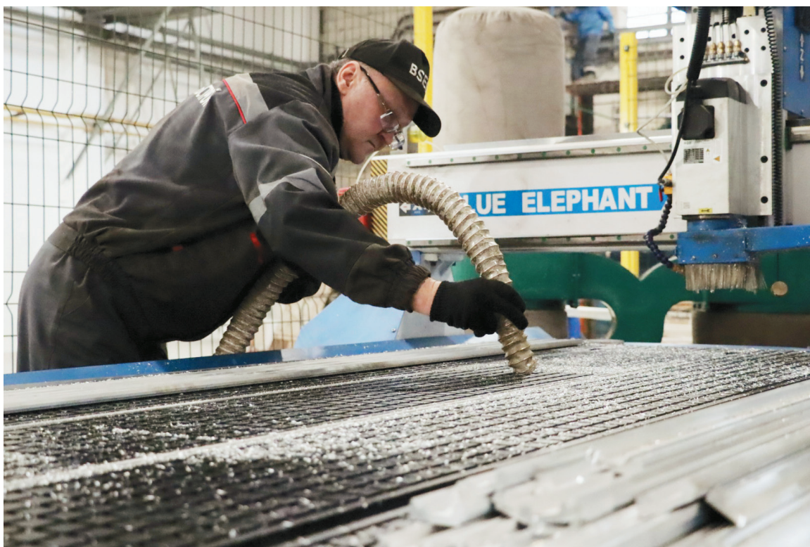
Процесс очистки фрезерного стола для производства прокалывающих элементов
